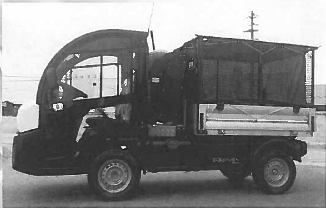
**Sistema de alta pressão amovível, montado entre a cabine a caixa de carga, equipado com:**
