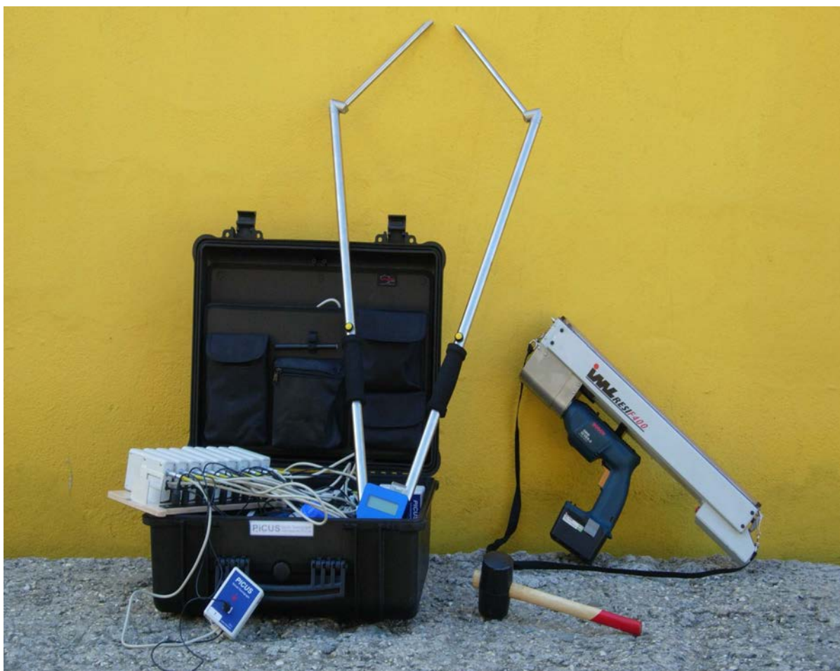
Figura 1: Equipamentos utilizados nos Estudos de Avaliação de Risco (tomógrafo, resistógrafo e martelo de borracha).
