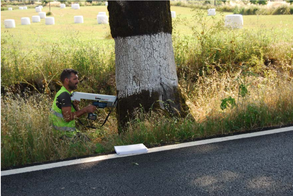
Figura 2: Exemplo da utilização do resistógrafo para análise da resistência biomecânica do tronco.
