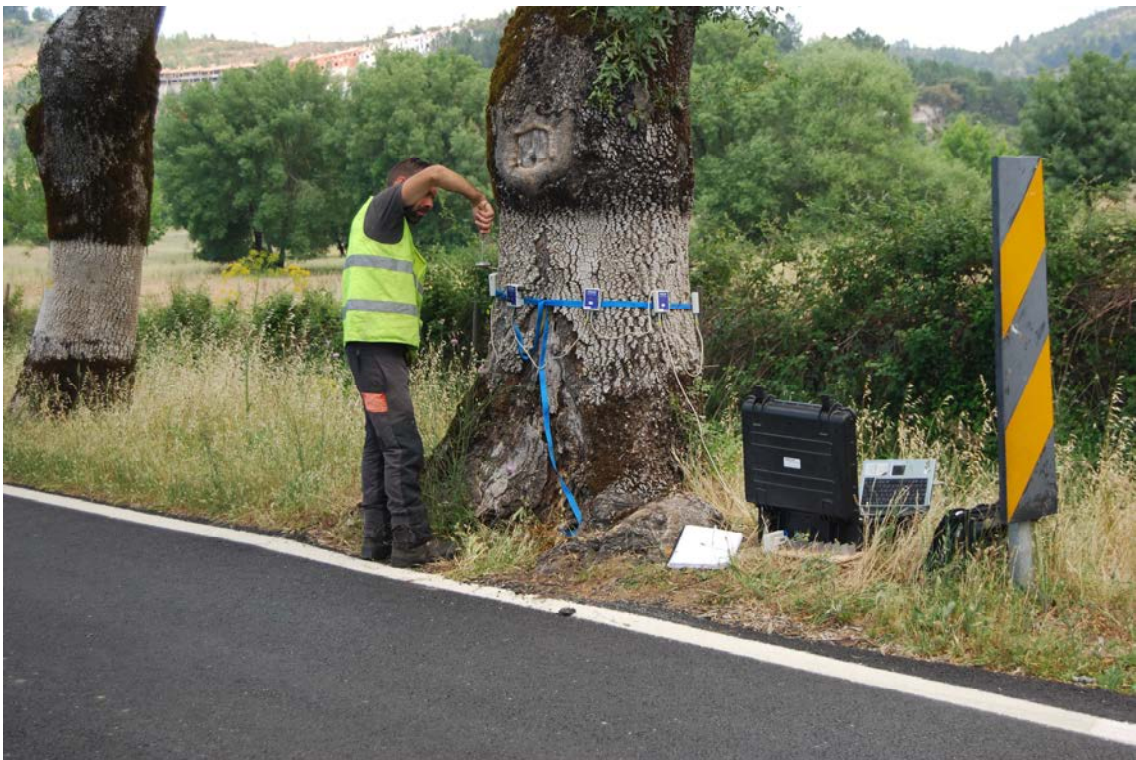
Figura 4: Utilização do tomógrafo para análise da situação biomecânica.
